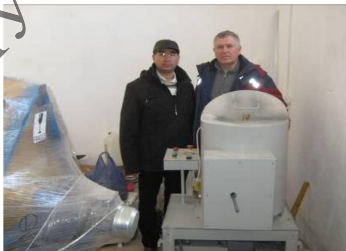
Рисунок 4 – Гранулятор для дражирования семян саксаула черного и сосны обыкновенной
