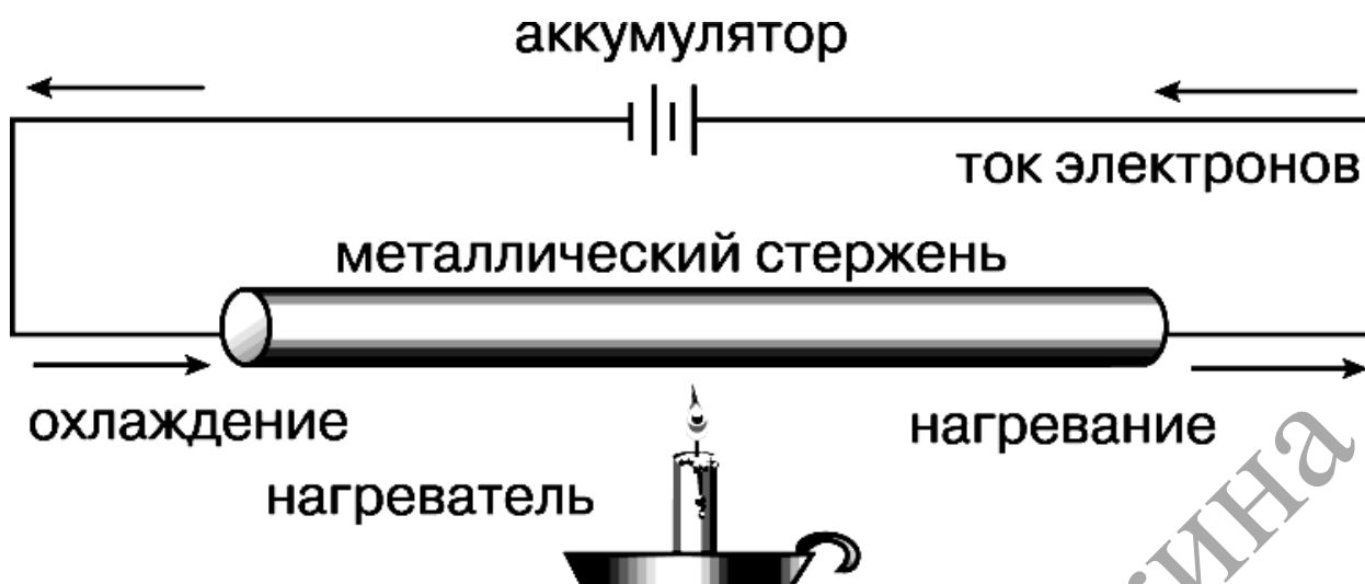
Рисунок 5. – Выделение или поглощение дополнительной теплоты Томсона в зависимости от направления тока
