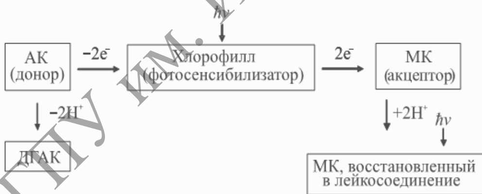
Рисунок 2.7. – Схема транспорта электрона в окислительно-восстановительной реакции фотохимической стадии фотосинтеза
