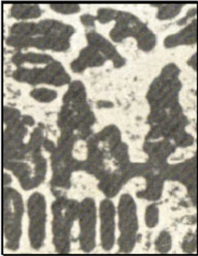
Рисунок 9.5. – Микроструктура однофазной оловянистой бронзы (5% Sn). Травление хлористой меди и аммония; \times 250
