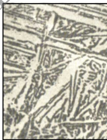
Рисунок 9.9. – Микроструктура закаленной алюминиевой бронзы (10,5% Al); x 250
