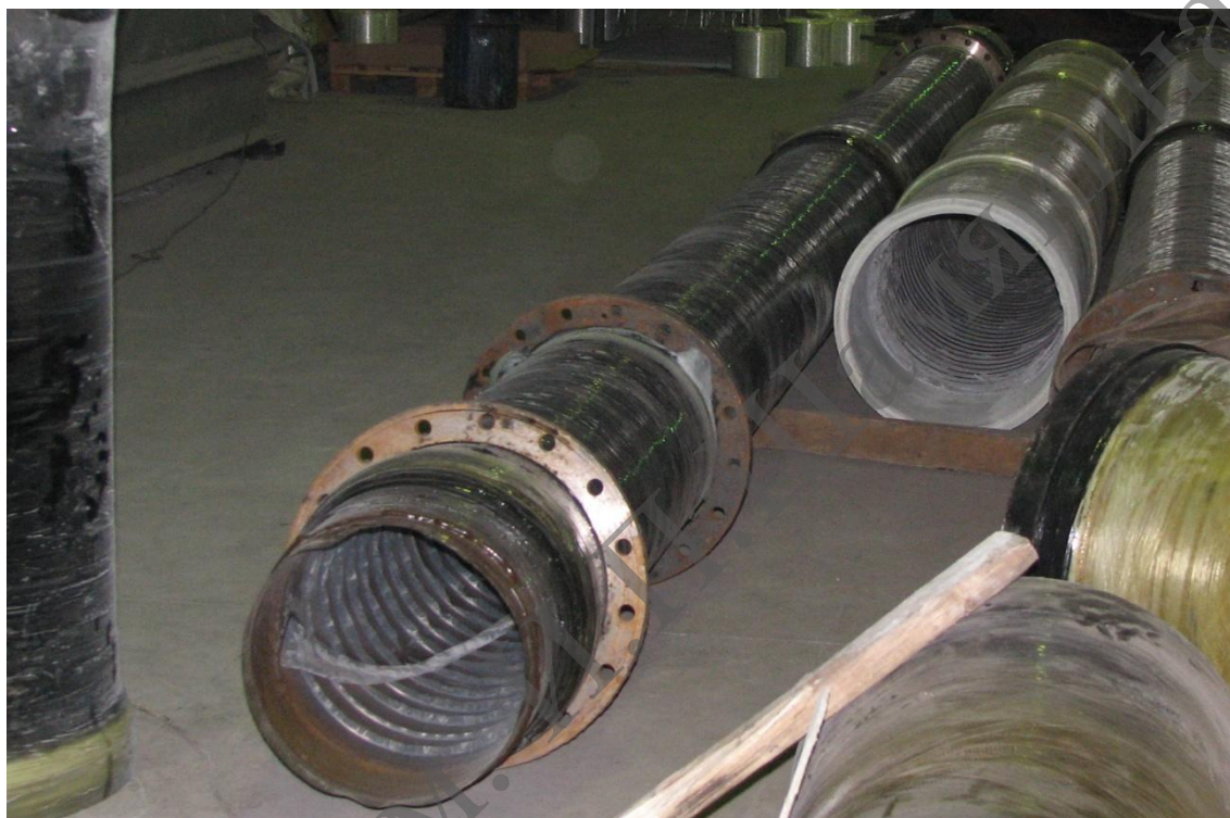
Рисунок 3 – Образцы бипластмассовой трубы, футерованной лентой ПВХ, обработанной поливинилацеталем
