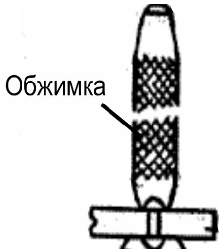
Рисунок 16.3 – Обжимка в работе
